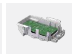
Utěsněná elektrická skříň a zesílený PCB povlak
